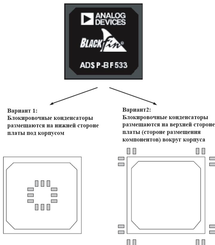
Рис. 18-5. Размещение блокировочных конденсаторов
