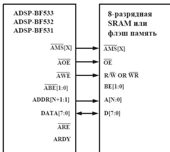
Рис. 18-1. Интерфейс с 8-разрядной SRAM или флэш-памятью
